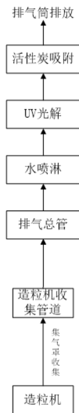
图 4.1-3 项目废气收集、处理工艺流程图
