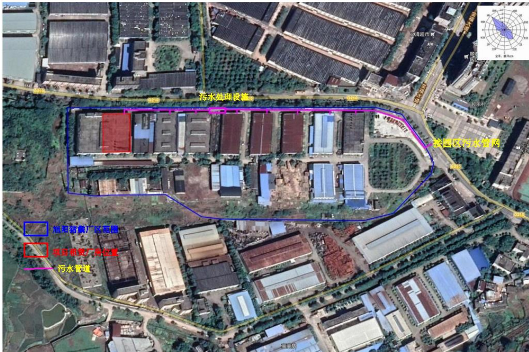
图4.1-2 全厂废水及雨水流向示意图
